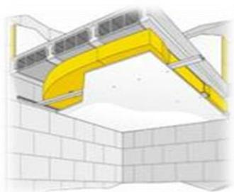
Plancher isolé en sous-face de dalle
